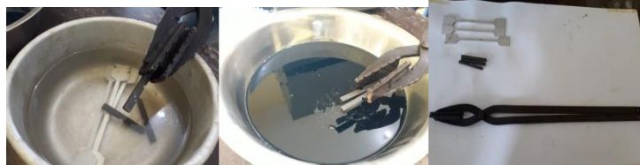
Gambar 2.5 Mendinginkan Benda Uji Dengan Media (A) Air, (B) Oli, (C) Udara.
