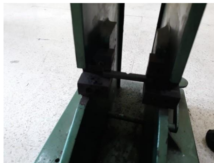
Gambar 3.5 Peletakkan Posisi Benda Kerja Sebelum Di uji
