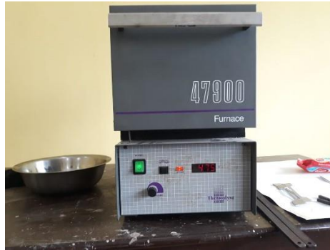
Gambar 2.1 Elektrik Furnace (Dapur Tinggi Listrik)
