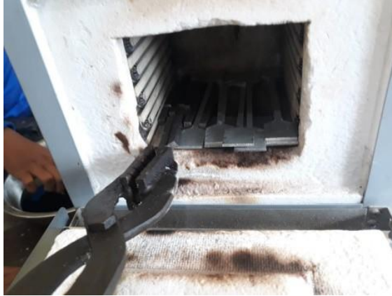
Gambar 2.4 Memanaskan Benda Uji
